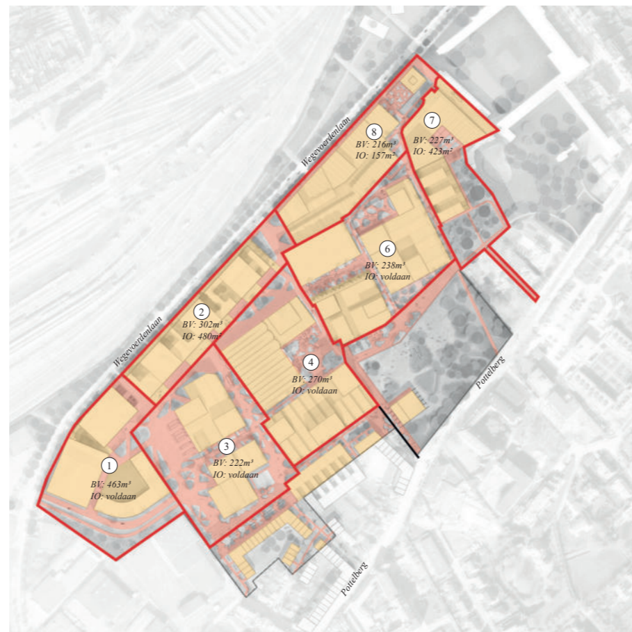
Te bufferen volumes en infiltratieoppervlaktes per deelzone in het projectgebied OMGEVING & UAUcollectiv
