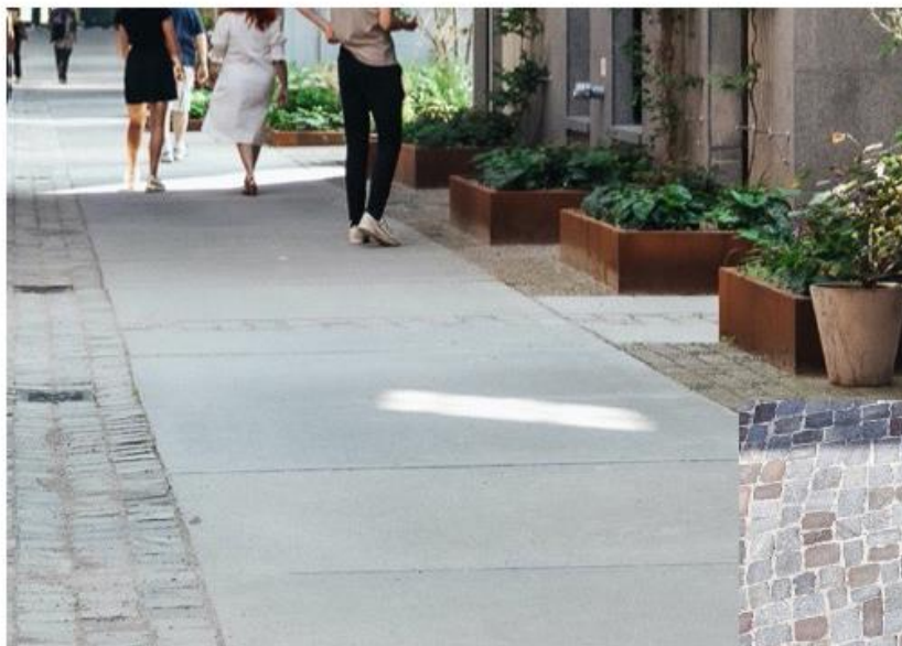
betonstrook indien hoofdfietsroute door steeg
