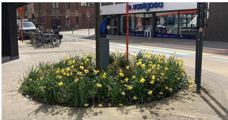
Figuur 36. Plantvak zonder borduur, waar afstroom van de aanpalende verharding in kan infiltreren op de Heuleplaats (Kortrijk).
