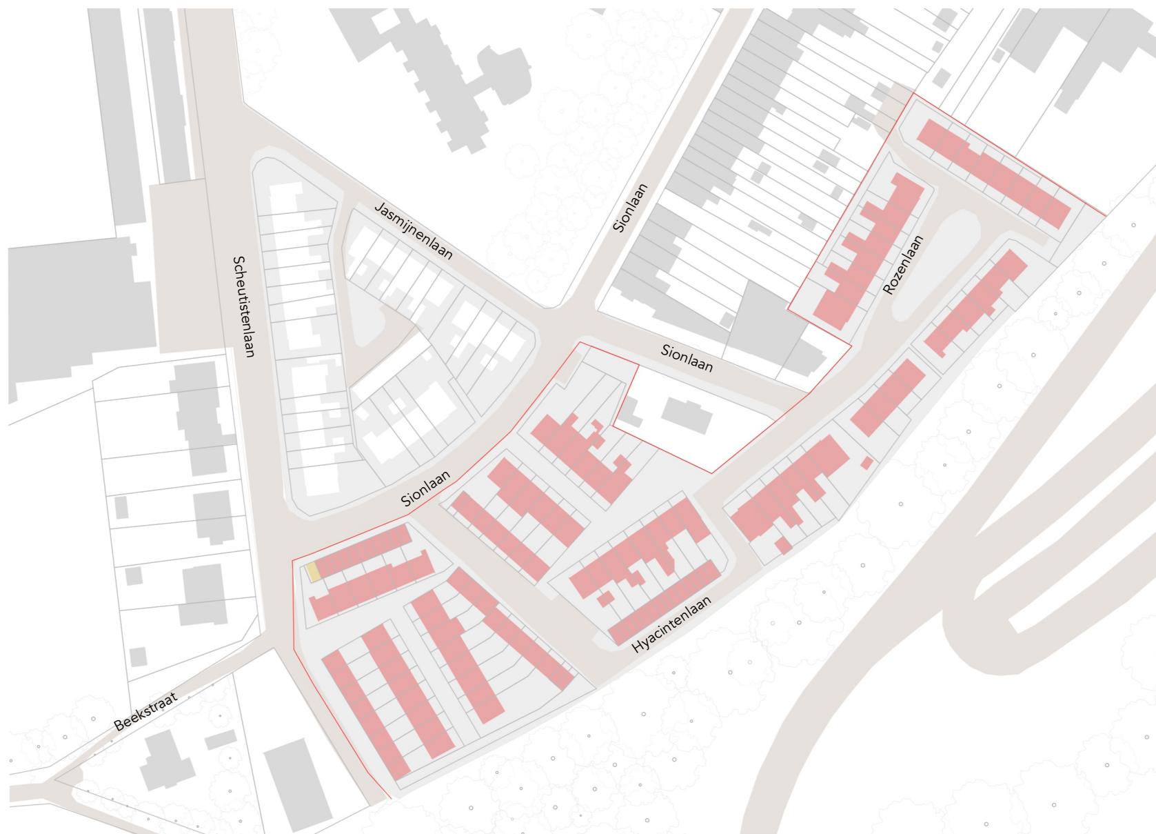
1 sloop bestaande woningen fase 1, met uitzondering van de hoogspanningscabine
