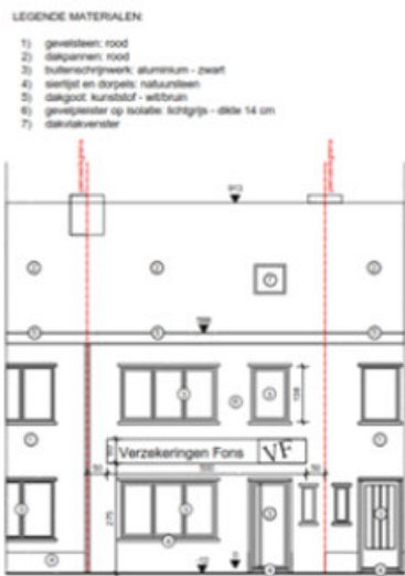
Voorgevel bestaande toestand
